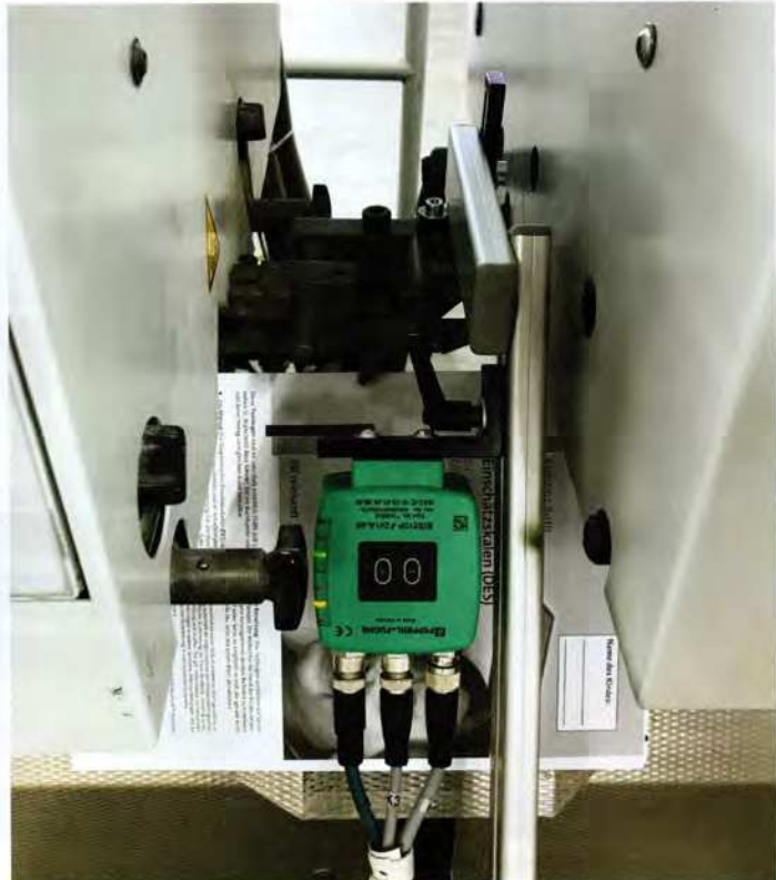
Professionelles Kamerasystem: Ausgestattet mit einem „Vision Sensor“ von Pepperl & Fuchs, ist das Kamerasystem für die Nachrüstung an Sammelheftern und Klebebindern vorgesehen.
