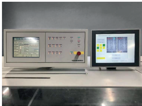
→ Panel PC neben dem Bedienfeld des Stitchmaster ST 450 Sammelhefters
